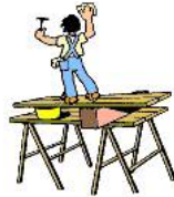
Fig. 4: Altura de la plataforma de trabajo conseguida de forma insegura
