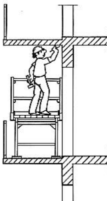
Fig. 9: Andamio situado en voladizo
